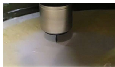
旧型MCTを用いた Ø0.1のセラミック穴あけ加工は、 コレットさえ正確に使えば、 だれでもØ0.1の穴あけ加工ができます。
