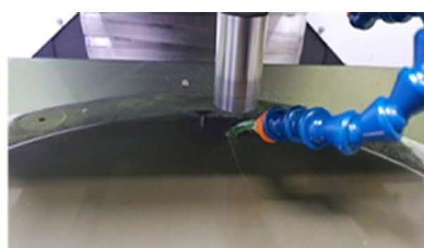
超音波(Ultrasonic)スピンドルを用いた セラミックØ0.1の穴あけ加工
